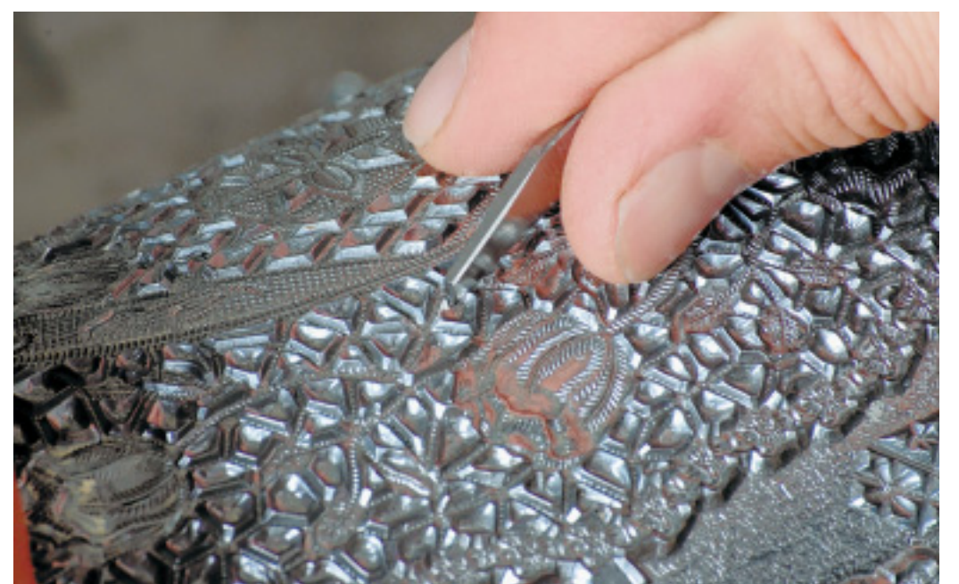
Handarbeit: Die Gravurwalzen für die Tortendecken sind eine echte Kunst. Mehrere Wochen kann es dauern, bis das Muster eingekerbt ist.
